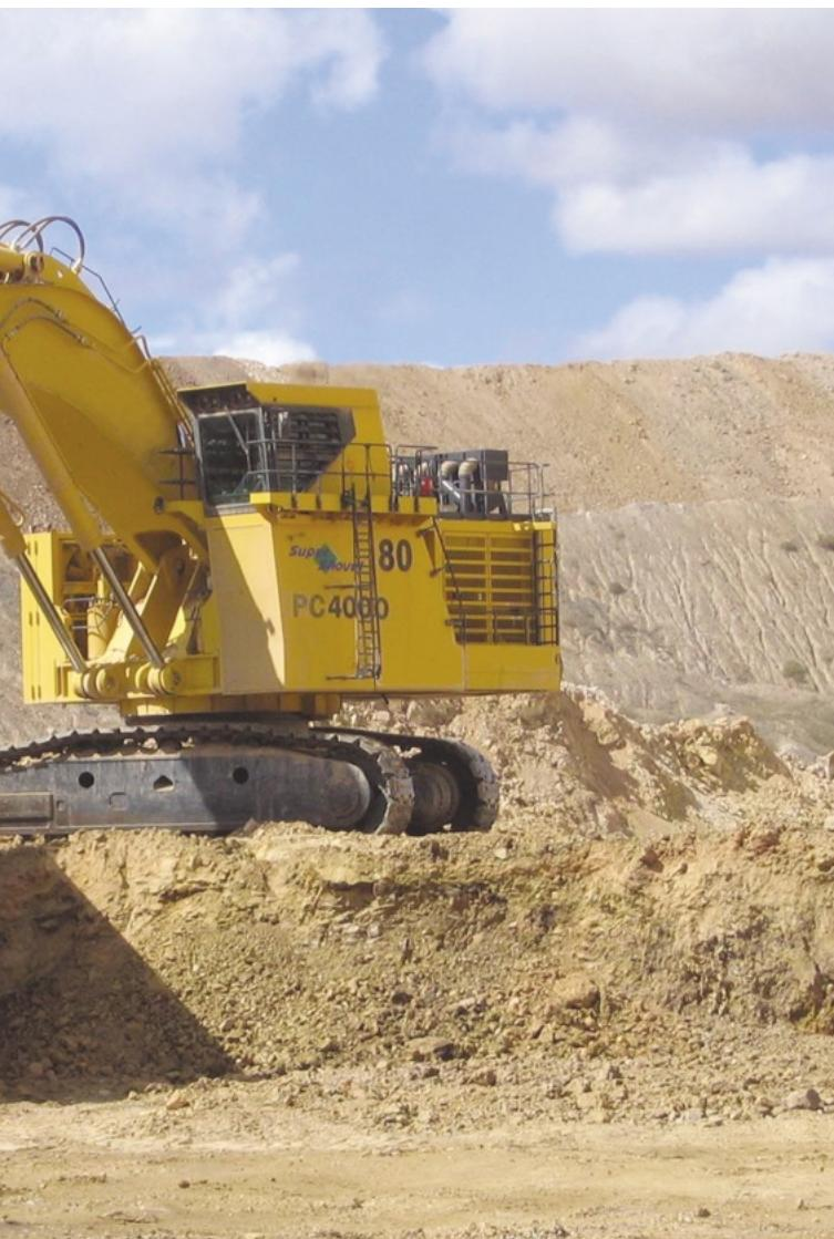
Рассчитан на работу с карьерными самосвалами грузоподъемностью 136 - 217 тонн (150 - 240 тонн США)
